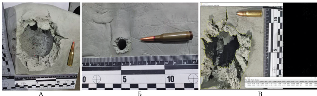
Рис. 1. Вхідні кульові отвори від пострілів: А) патроном 5,45x39 мм спорядженого експансивними кулями типу «V-Max; Б) неекспансивним військовим патроном 5,45 мм з кулями «ПС» зі сталевим осердям «7Н6»; В) патроном 7,62 мм з експансивними властивостями. Наведені планіметричні показники вхідного кульового отвору, розраховані програмним шляхом
